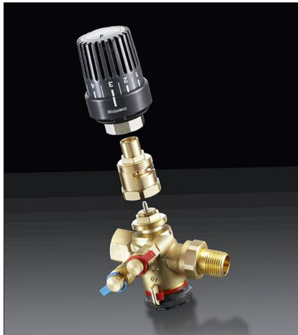
Abb. 10: Differenzdruckunabhängiges Regulierventil mit Rücklauftemperaturbegrenzer und Adapter für Mindestdurchfluss bei Einrohrkreisen
