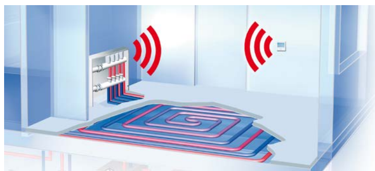
Abbildung 15: Regelung der Fußbodenheizung/-kühlung
