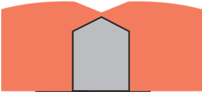
Darstellung der unzulässigen Bereiche nach Vorgabe des VDI 3781-4 (rot dargestellt, T. Hinrichs), ohne Berücksichtigung der Nachbarbebauung oder Topographie.
